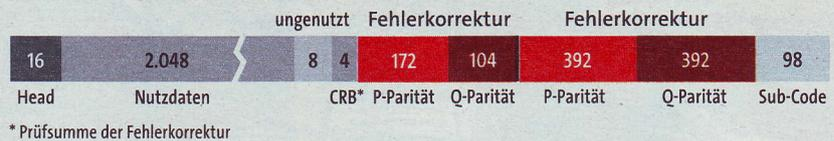
werden zuerst errechnet, so dass die Frames jetzt 24 Byte Nutzdaten und 4 Byte Fehlerkorrektur umfassen. Diese werden per Interleaving auseinander gerissen. Die neue Bit-Folge lässt sich wiederum in 28-Byte-Blöcken zusammenfassen. Für die neuen Blöcke werden jetzt die P-Paritäts-Bytes ermittelt, so dass man 32-Byte-Frames erhält.
